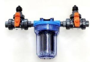
Проточный (OFF-LINE) CARB. комплект для обвязки датчика хлора SCLO 3 (HYCHLOR). Max. температура – до 45 °C. Max. противодавление в системе – до 5 бар. Предназначен для обвязки, калибровки нулевого значения остаточного хлора. Подсоединения: 1/2". В состав монтажного комплекта входит: 3-хходовой кран ПВХ 1/2" – 2 шт., шланг ПВХ(ПЭ) 10x14 – 40 см, фильтр с картриджем из активированного угля; соединительный фитинг, кронштейн крепления на стену, саморезы.
