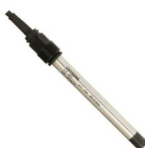
Датчик для измерения растворенного кислорода. Корпус датчика выполнен из нержавеющей стали, мембрана с платиновым/серебренным электродами. Диапазон измерений: 0-20 ppm. MAX. рабочая температура - 60° C. Диапазон рабочего давления в системе: 0-4 бар. Диаметр корпуса: 12 мм. Резьба на корпусе PG13.5. Соединительный кабель - 5 м.
