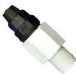
Стандартный клапан впрыска реагента для перистальтических насосов до 12 л/ч. Подсоединение - 3/8" на шланг 4x6. Материал исполнения: полипропилен – Витон.
