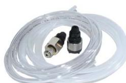
Комплект клапанов забора/подачи реагентов для перистальтических насосов до 12 л/ч. Состав: клапан впрыска, клапан забора, шланг забора ПВХ 4x6 - 2 м.п., шланг подачи ПЭ 4x6 - 3 м.п.
