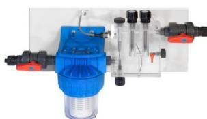
Проточный (OFF-LINE) держатель датчиков PH-RX (FS) с монтажным комплектом в комплекте с датчиком потока [2 FILI N.C.]. Max. температура – до 45 °C. Max. противодавление в системе – до 5 бар. Подсоединения: ниппель 1/2" на шланг 10x14. В состав монтажного комплекта входит: шланг ПВХ 10x14 - 10 м. п., кран ПВХ 3/8" – 2 шт., префильтр с картриджем 150 микрон; соединительный фитинг, кронштейн крепления на стену, саморезы Совместим только с насосами-дозаторами серий DLX(B) PH-RX/MBB и BT PH-RX/MBB.
