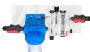
Проточный (OFF-LINE) держатель датчиков PH-CL (FS) с монтажным комплектом, включая датчик потока. Max. температура – до 45 °C. Max. противодавление в системе – до 5 бар. Подсоединения: ниппель 1/2" на шланг 10x14. В состав монтажного комплекта входит: шланг ПВХ 10x14 - 10 м. п., кран ПВХ 3/8" – 2 шт., префильтр с картриджем 150 микрон; соединительный фитинг, кронштейн крепления на стену, саморезы
