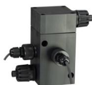
Датчик выходного потока для определения мутности, работает по методу NTU с помощью фотодиода, который определяет количество отраженного света. Диапазон измерений: 0-1000 NTU. Исполнение: корпус датчика изготовлен из ПВХ. Для корректной работы датчика, необходим постоянный поток в интервале 1-15 л/ч. Max. противодавление в системе - 1 бар. Max. температура: 60°C. Подсоединения: 1/2" на шланг 10x14.
