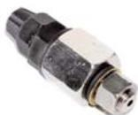
Клапан впрыска реагента с шаровым подпружиненным клапаном. Подсоединение: 1/8" на шланг 4x6. Материал исполнения: ПП/никелированная латунь; шаровой клапан: н/ст.
