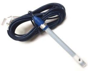
Датчики электропроводности PTFE с электродами из графита и с интегрированным датчиком температуры. Данный тип датчиков может быть установлен в погружной держатель датчиков. Диаметр - 12 мм, длина - 120 мм.
