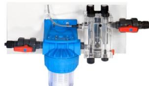
Проточный (OFF-LINE) держатель датчиков PH-RX-CL (FS) с монтажным комплектом, включая датчик потока. Max. температура – до 45 °C. Max. противодавление в системе – до 5 бар. Подсоединения: ниппель 1/2" на шланг 10x14. В состав монтажного комплекта входит: шланг ПВХ 10x14 - 10 м. п., кран ПВХ 3/8" – 2 шт., префильтр с картриджем 150 микрон; соединительный фитинг, кронштейн крепления на стену, саморезы
