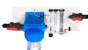
Проточный (OFF-LINE) держатель датчика SONDA CL (FS) с монтажным комплектом в комплекте с датчиком потока. Max. температура – до 45 °C. Max. противодавление в системе – до 5 бар. Подсоединения: ниппель 1/2" на шланг 10x14. В состав монтажного комплекта входит: шланг ПВХ 10x14 - 10 м. п., кран ПВХ 3/8" – 2 шт., префильтр с картриджем 150 микрон; соединительный фитинг, кронштейн крепления на стену, саморезы
