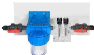
Проточный (OFF-LINE) держатель датчиков PH-RX с монтажным комплектом. Без датчика потока. Max. температура – до 45 °C. Max. противодавление в системе – до 5 бар. Подсоединения: ниппель 3/8" на шланг 10x14. В состав монтажного комплекта входит: шланг ПВХ 10x14 - 10 м. п., кран ПВХ 3/8" – 3 шт., префильтр с картриджем 150 микрон; соединительный фитинг, кронштейн крепления на стену, саморезы.
