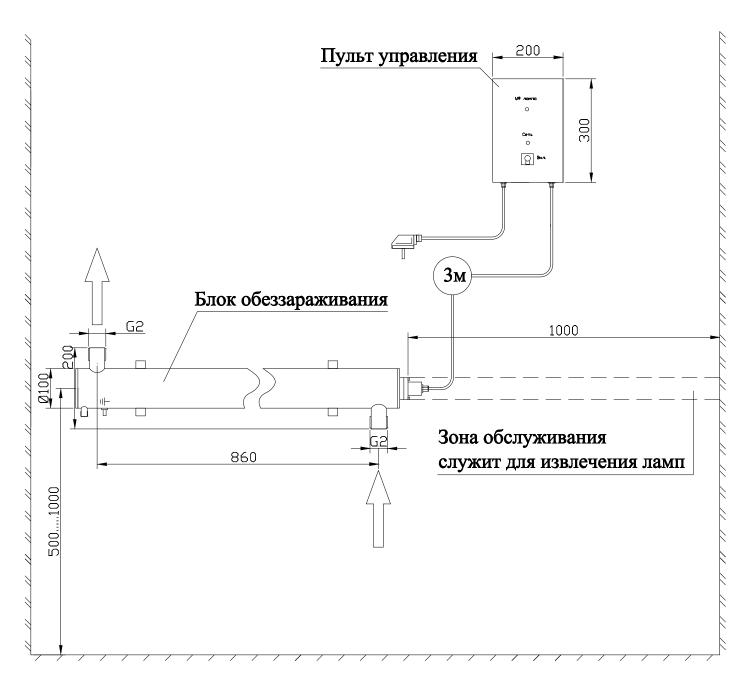
Примечание: монтаж установки к стене производиться при помощи двух хомутов Ø100 мм.
